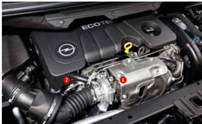
3 A gépkocsiba szerelt 1,6 CDTI motoron is könnyen elérhetők az olaj előszűrő (2) és a turbó olaj nyomóvezetékek (6) csatlakozásai
