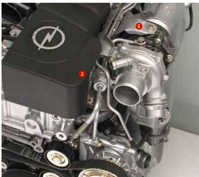
2 - olaj előszűrő, 6 - olajbevezetés a turbó középrészbe
