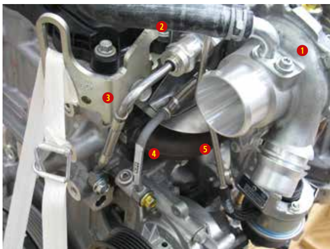
1 - turbótöltő, 2 - olaj előszűrő, 3 - olaj-nyomóvezeték, 4 - turbó hűtővíz bevezető cső, 5 - VTG vákuumcső
