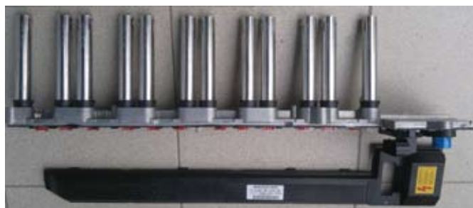
8. ábra: N92/1 gyújtómodul leszerelt védőburkolattal
