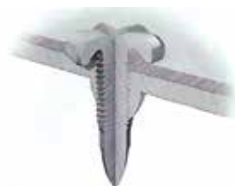
⑤ Az önmetsző csavar a kúpjának forgásából keletkező súrlódási hővel megfolyatja az anyagot és így jut át rajta, miközben menetet formál bele
