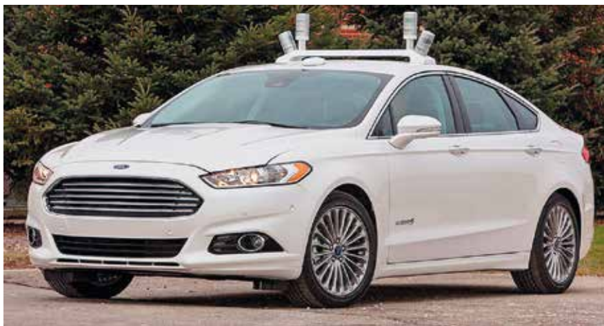
A Ford vezetői asszisztens fejlesztő járművét két-két, körbe forgó, állandó tükrű, kisebb méretű Lidar különbözteti meg az autonóm irányítású járművek költséges Lidarjától
