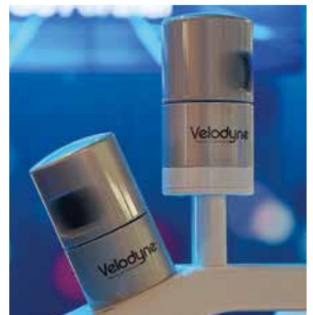
A Ford párban használt Lidarok közül a függőleges tengely körül forgó, állandó tükrű távérzékelő a vízszintes, a ferde tengelyű a függőleges síkban mér
