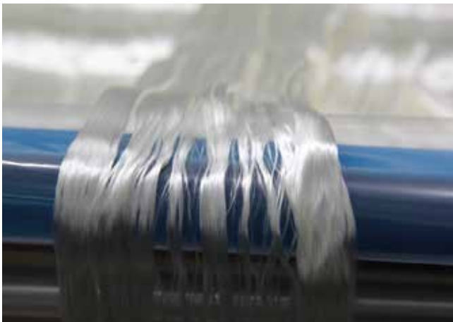
Az egyes poliakrilnitril pászma 100 000 szálból áll, melyből 2 szén-szál köteg lesz, egyenként 50-50 ezer karbonszállal
