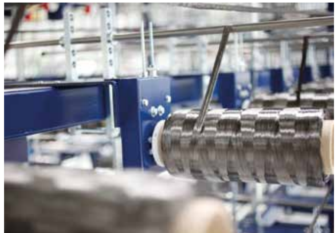
a csévelt karbonszál pászma a szén-szál szövet alapanyaga
