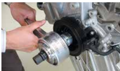
Szíjtárcsa rögzítőcsavar meghúzása nyomatéksokszorozóval
