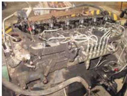
❶ Felújítási munka alatt álló ISUZU dízel, common rail injektorai ellenőrző vizsgálaton kell, hogy áteszenek
