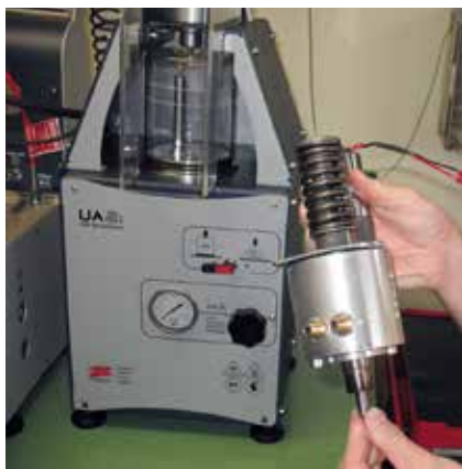
❸ A PD- (UI) elem vizsgálatához az injektort a vizsgálóolaj-ellátást biztosító adapterbe kell behelyezni
