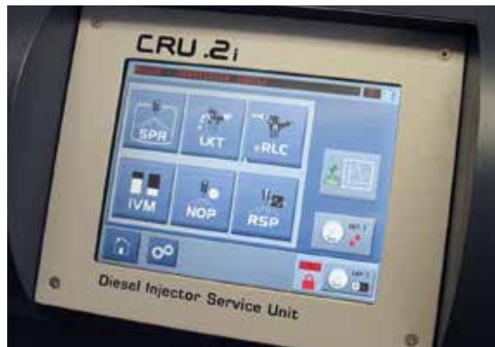
❷ A CRU.2i mérési funkciói: SPR-teszt: befecskendezési sugárkép vizsgálat, LKT-teszt: injektorszivárgás teszt, eRLC: injektor elektromos teszt ellenállás és induktivitás ellenőrzése, IVM: injektormennyiség teszt (szállított és résolajmennyiség mérése), NOP: injektor szállításkorlat teszt és RSP-teszt: injektor reakcióidő vizsgálat
