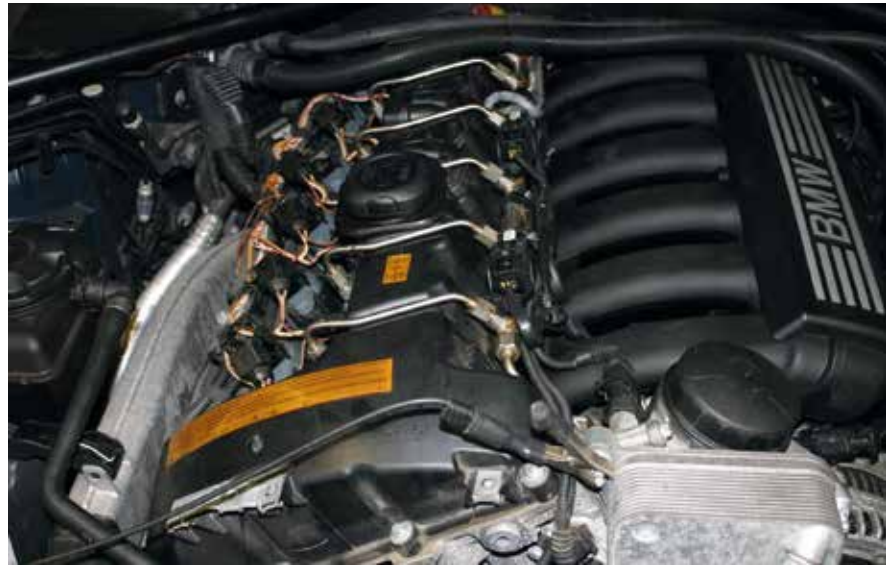
A 2008-as évjáratú, 523i típusmegjelölésű kocsiban egy 2,5 literes, N53B25A kódú, közvetlen befecskendezésű motor dolgozik, 140 kW teljesítménnyel.
