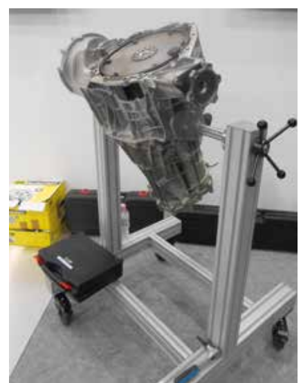
LuK tengelykapcsoló modullal szerelt váltó: a féltengelykihajtás a tengelykapcsoló elé kerül
