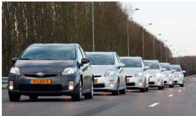
Az egymást kis távolságban követő, együtt vezérelt mozgású konvoj járművek fogyasztása személy-...
