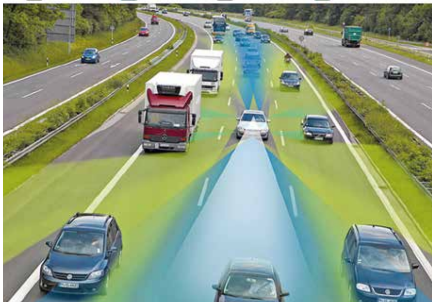
A járművek pontos irányítását a forgalmi áramlatban már ma is lézer, radar, videó és ultrahang-érzékelők jelei segítik
