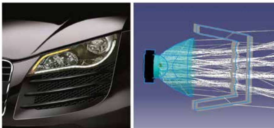
8 Az irányjelző az R8-ban és a fényeloszlás létrehozásának elve
