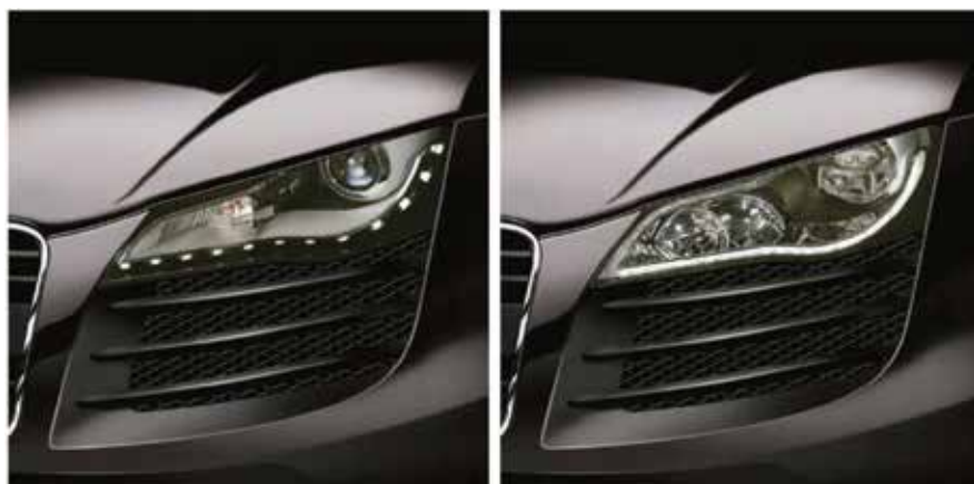
⑤ Audi R8 menetjelző fényei bi-xenon (bal) és LED- (jobb) fényszóróval
