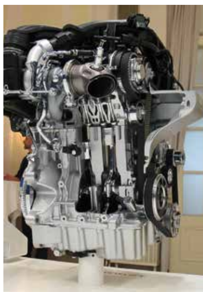
A 3-hengerű TDI-motor jeladói: szívólevegő-hőmérő, vízhőmérő, kopogásdetektor és a PSG (égéstéri gáznomás érzékelő izzógyertya)
