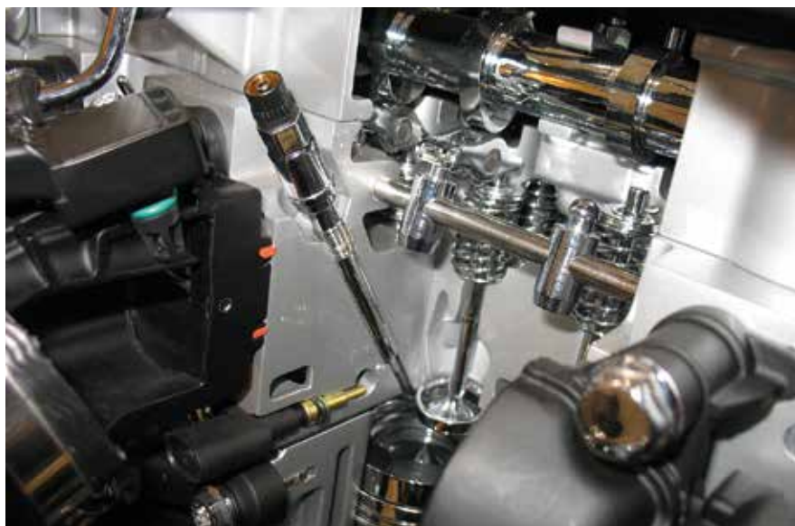
A 3-hengerű TDI-motor jeladói: szívólevegő-hőmérő, vízhőmérő, kopogásdetektor és a PSG (égéstéri gáznomás érzékelő izzógyertya)
