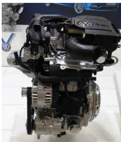
Az új 3 hengerű, turbófeltöltött Otto-motor, a 81 kW teljesítményű, 1,0 literes TSI-motor
