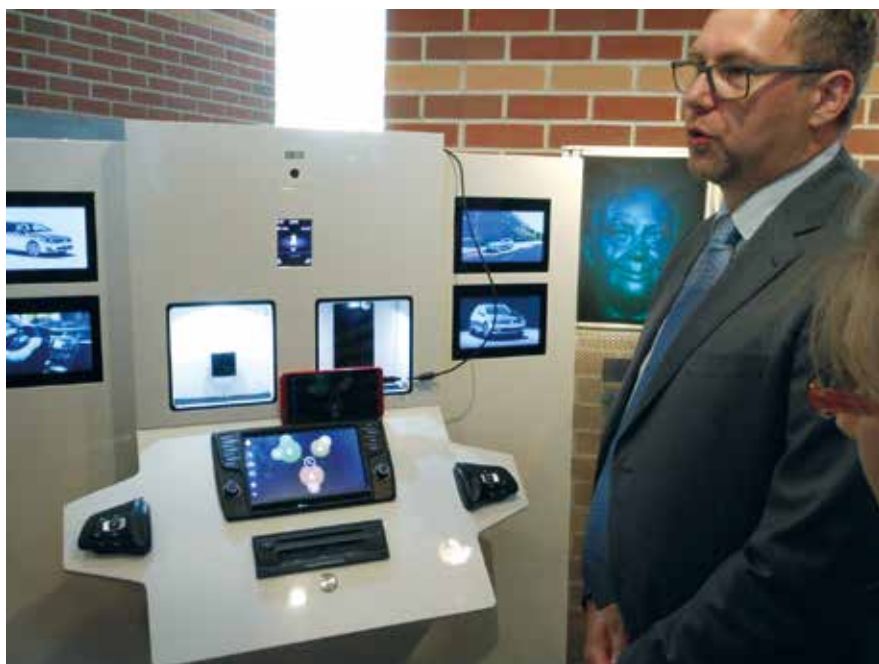
2 A „Mirror link” funkcióval az androidos okostelefonunk köthető össze az autóval, így a kijelző telefonná válik.
