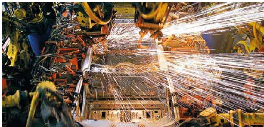
A korszerű hegesztési eljárások jelentősen szűkítik a robotokkal végzett villamos ponthegesztés alkalmazását
