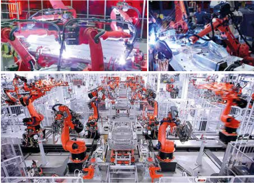
A mindinkább terjedő kis hőbevitelű CMT (a) és a lézerhegesztő (b) robotok nemcsak a minőséget javítják, hanem a munkásokat is kiszorítják a korszerű járművek kocsiszekrénygyártásából
