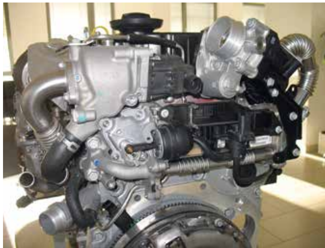
11 Kipufogógáz-visszavezetés (hűtő- és RGR-szelep)
