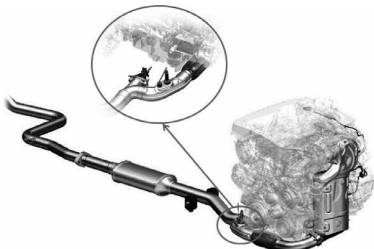
17 Az SCR-emissziótechnika és az AdBlue injektor elhelyezése
