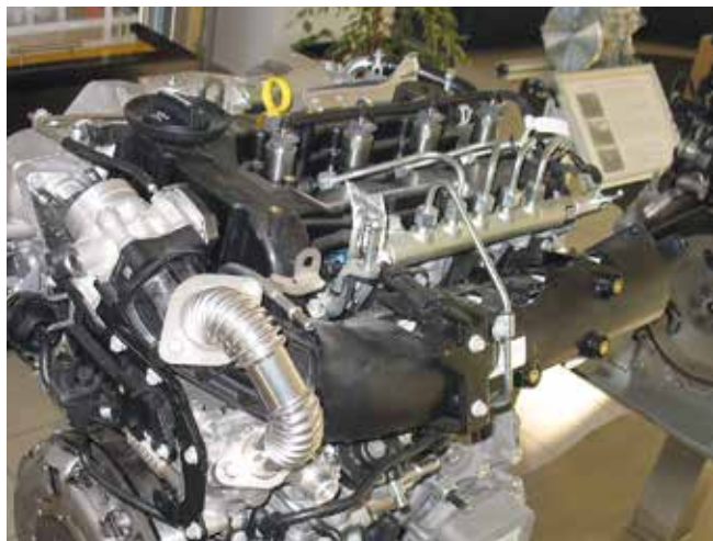
10 A szívócső burkolata a zajcsökkentést szolgálja
