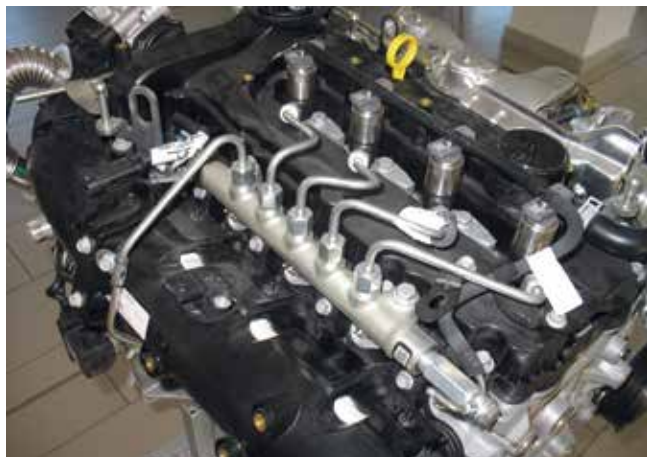
7 A Denso közös nyomócső és a CR-injektorkok
