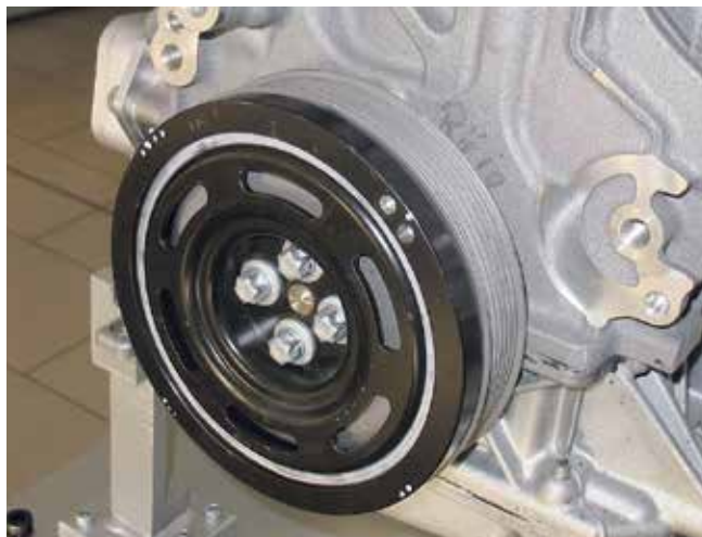
16 Szíjtárcsa integrált főtengely torziós lengéscsillapítóval (TVD)
