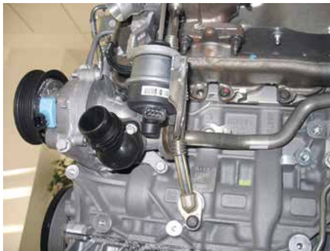
14 A VTG turbótöltő állítóműve útdóval
