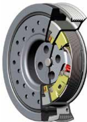
15 A főtengely lengéscsillapító (TVD) szerkezete
