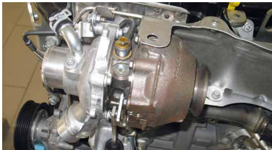
12 BorgWarner gyártmányú VTG turbóöltő
