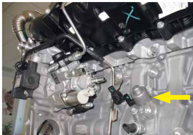
6 A Denso CR nagynyomású szivattyú
