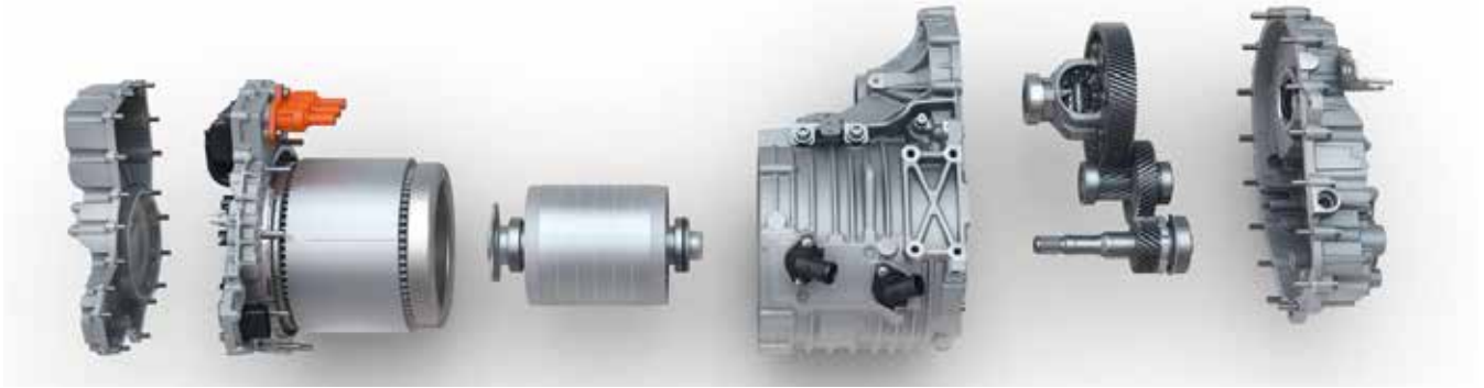
4 A V141 jelű háromfázisú motor 60 kW és 210 Nm leadására képes.
