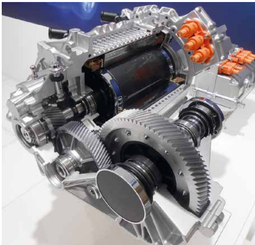
6 Az egyfokozatú váltómű (OCZ) a háromfázisú motorral egy egységet alkot.
