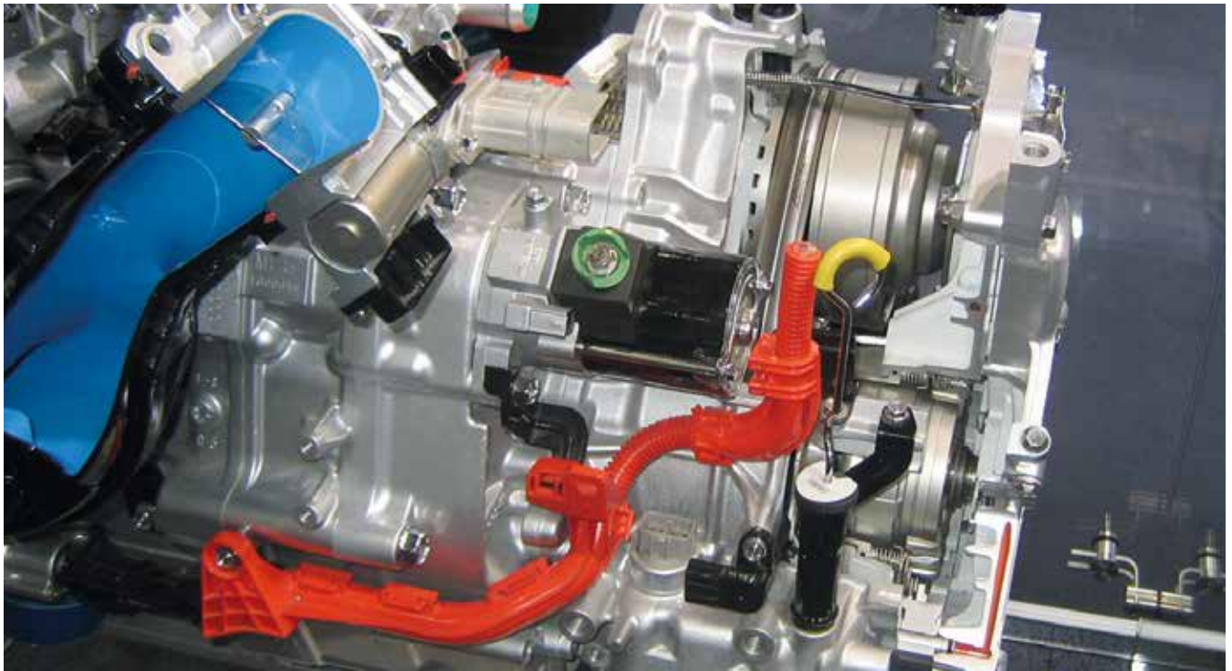
A légkondicionáló kompresszor nagyfeszültségű (HV) kábelének rögzítése
