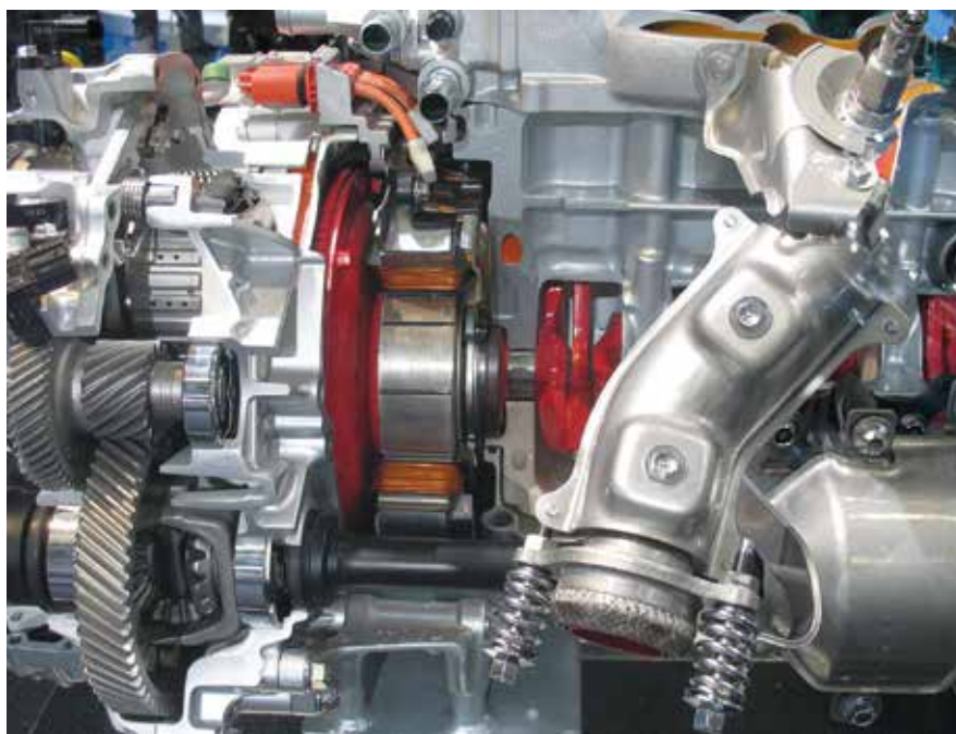
A belső égésű motor és a CVT-váltó közé ékelődő IMA-motor a fázisvezérlésekkel
