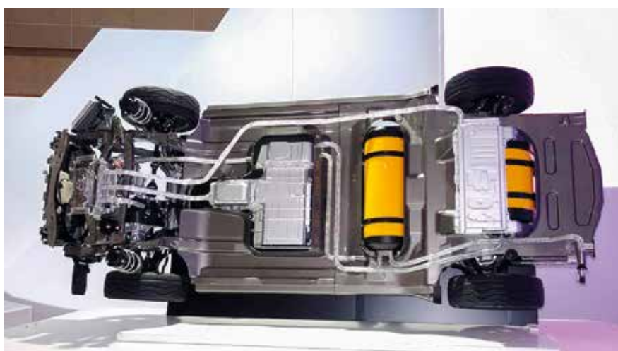
A minél mélyebb súlypont elérése érdekében a TC-hajtás minden fontos elemét a jármű padlólemezébe ágyazzák
