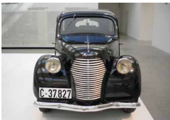
Škoda Popular 995 „Liduška” type 937 (1939) Az első Skoda Popular 1931-ben készült, számos műszaki újdonsága közül kiemelendő könnyűszerkezetes építésmódja. Népautónak szánták. A képen látható Liduška a legkisebb és legszerényebb felszereltségű modell, mely 1939–1949 között 1500 példányban készült.
