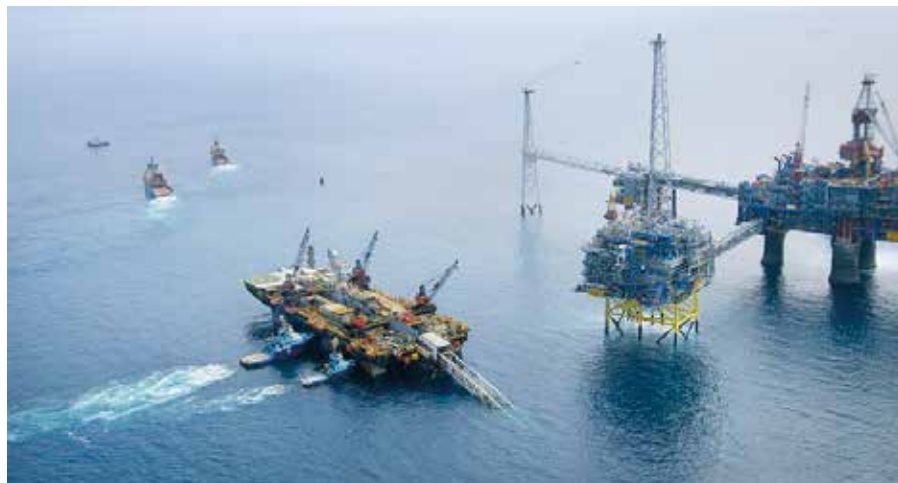
Csőfektető hajója az Acergy Piper, melyet épp tolóhajók állítanak irányba
