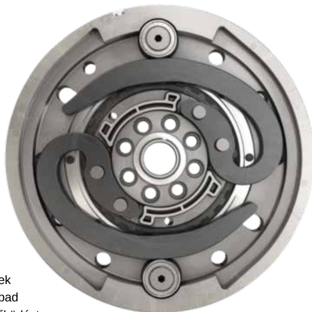
A Valeo által fejlesztett Blade kettős tömegű lendkerék
