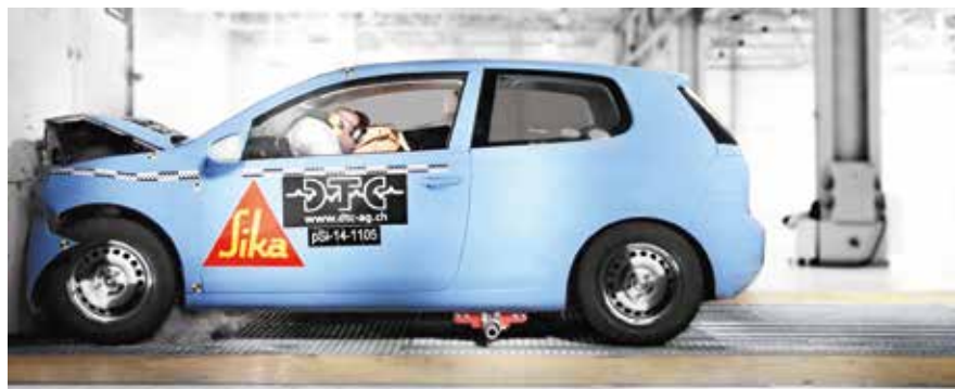
FMVSS 212/208 törésteszt, 30 perccel a szélvédő beragasztása után
