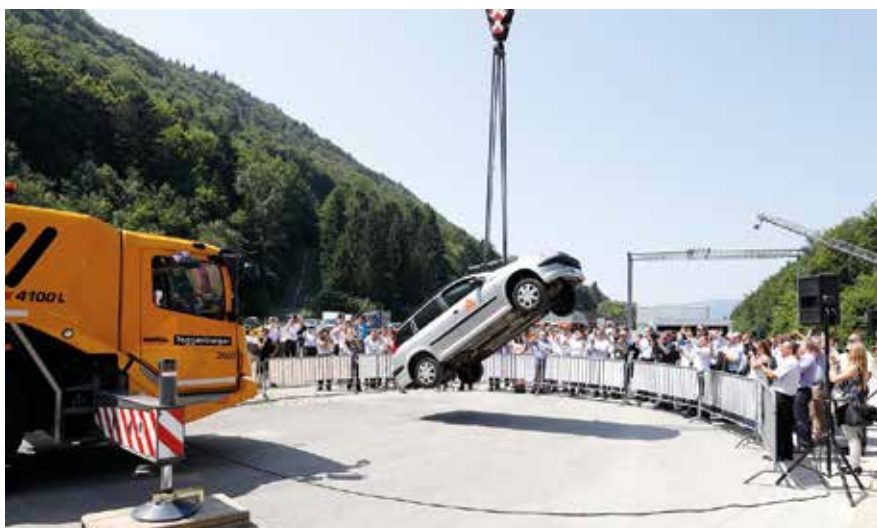
Peugeot 206 SW emelési tesztje a szélvédőnél fogva, 50 perccel a be- ragasztás után
