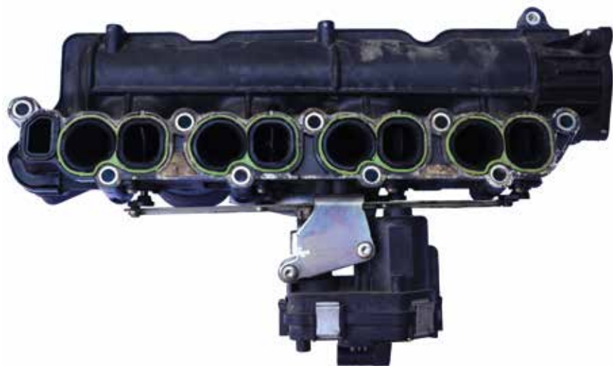
2 A leszerelt szívócső. Ennél a motornál minden hengerbe két szívócsövön keresztül áramlik be a levegő.
