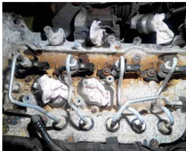
A hengerfejen a porlasztók körül jól láthatóak a víz okozta korrózió nyomai...
