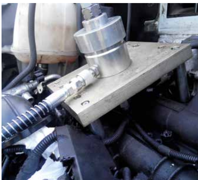
Iveco Daily 3.0 piezo porlasztó szakszerű kihúzatása, hidraulikus munkahengerrel. 15 tonna húzóerő volt szükséges.
