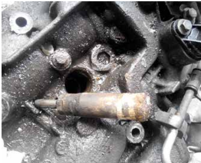
Az alsó rész is eltávolítható. Azonban ez is 12 tonna húzóerőnél adta meg magát...
