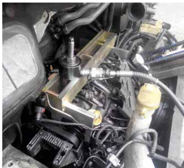
Renault Master 2.2, 2.5 dci, mágneskernyes porlasztó kihúzatása 12 tonna húzóerőnél.
