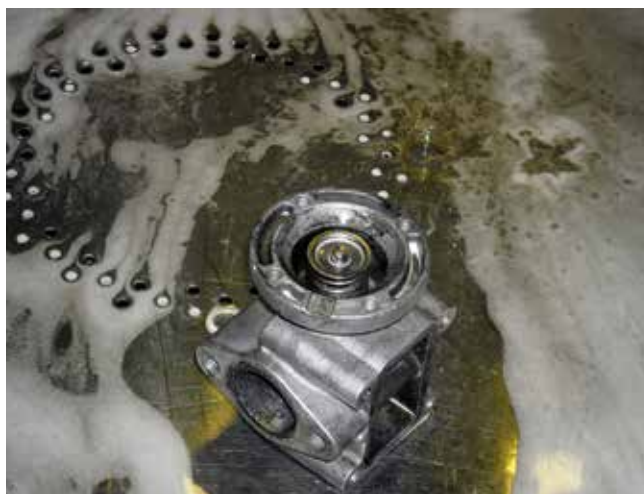
Multijet dízel EGR-szelep kétperces tisztítás után
