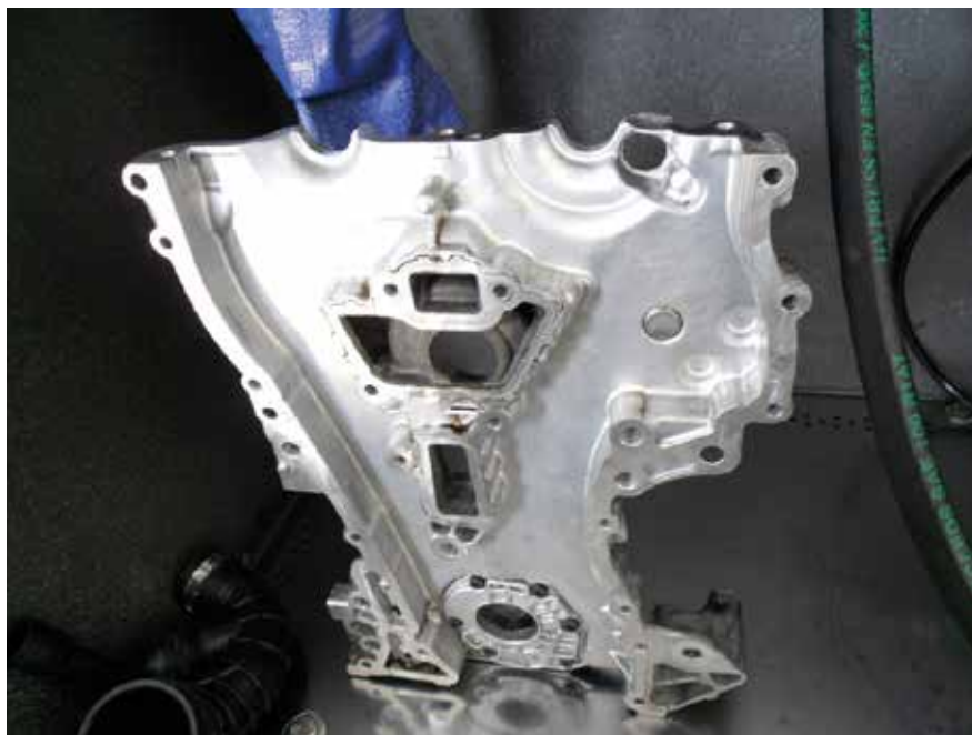
Opel Z14 XEP motor vezérműházfedél tisztítás után
