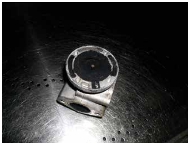
Multijet dízel EGR-szelep tisztítás előtt
