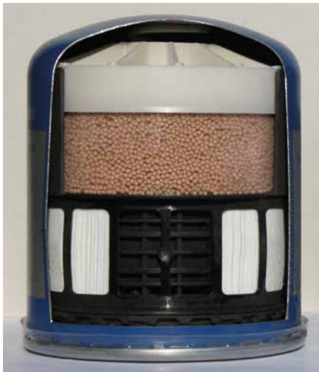
Betekintés az OSC légszárító szűrőpatron belsejébe
