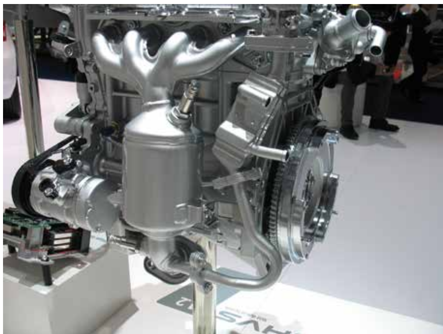
Duplafalú lemez kipufogó gyújtócső, motor közeli, 3 komponensre ható katalizátor, szabályzó és monitor lambda-szonda, EGR-gázélvétel a katalizátor utáni csőszakaszból, EGR-hűtő
