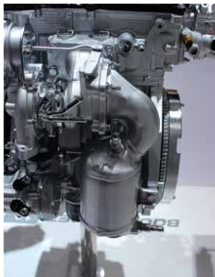
A motor közeli, 3 komponensre ható redox katalizátor, szabályzó- és monitor lambda-szondával
