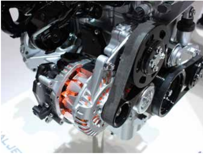
Denso indítógenerátor, a motor indítómotorral is rendelkezik
