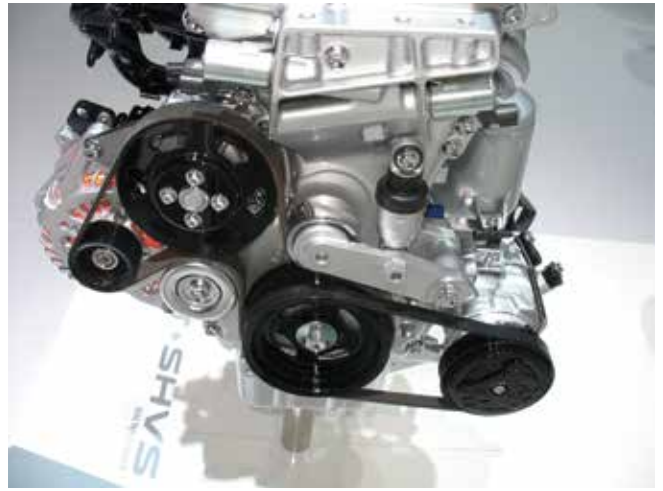
Az indítógenerátor szíjhajtása, szíjfesztése
