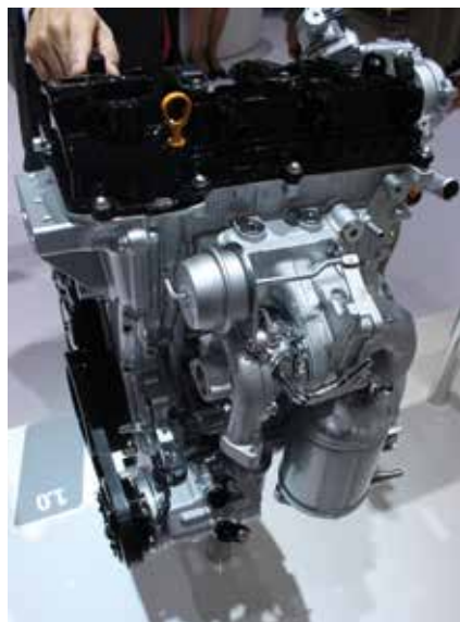
A kipufogó gyújtócső a hengerfej integrált része, a turbótöltő wastegate szabályozású, a középcsoport vízihűtésű
