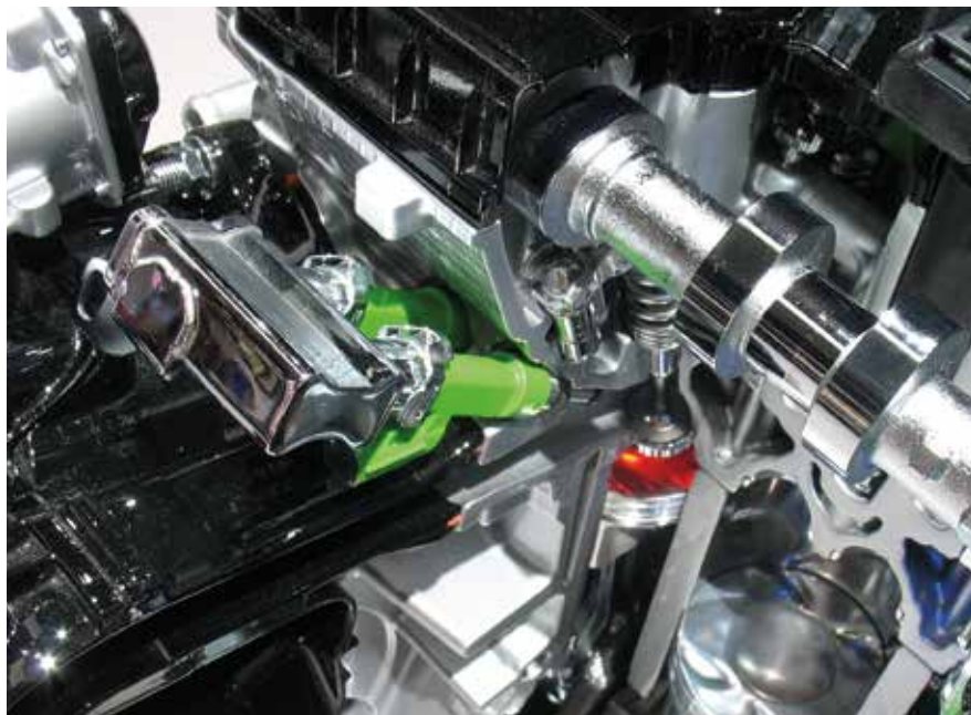
Hengerenként két szívószelep saját szívócsatornával, mindegyik csatornában 1-1 befecskendezőszelep
