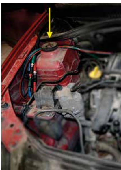
6 A mérőkábel becsípődött a jobb oldali torony alá, fotónkon sárga nyíl mutatja
