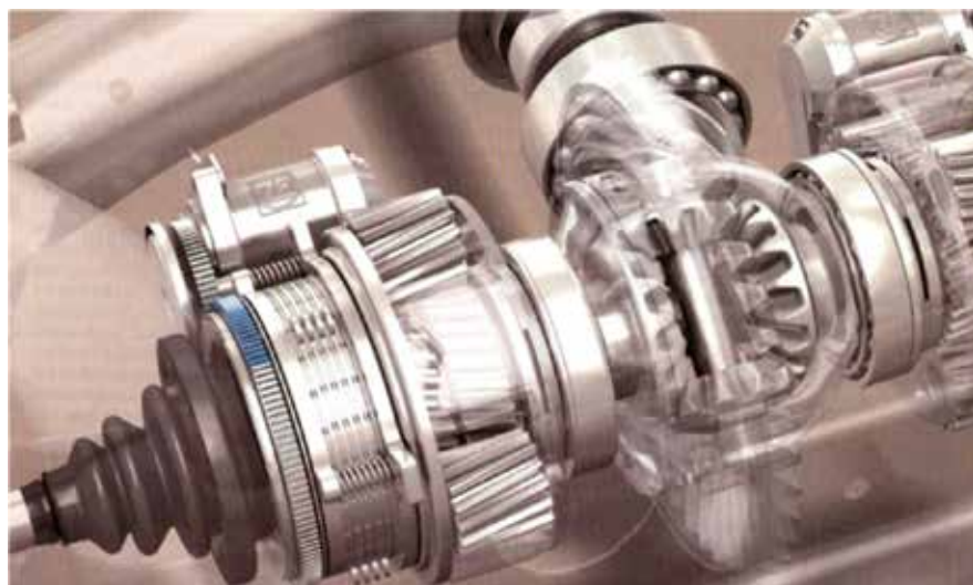
A torque vectoring nyomatékfelosztást lehetővé tevő ZF hajtóműegység
