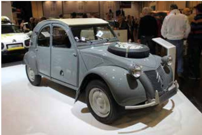
Kívülről csak a rendhagyó elhelyezkedésű pótkerék és az erős balesetvédelmi aggályokat felvető, első ajtókon kikanalító tankbetöltők sejtetnek valami turpisságot a „kacsán”
