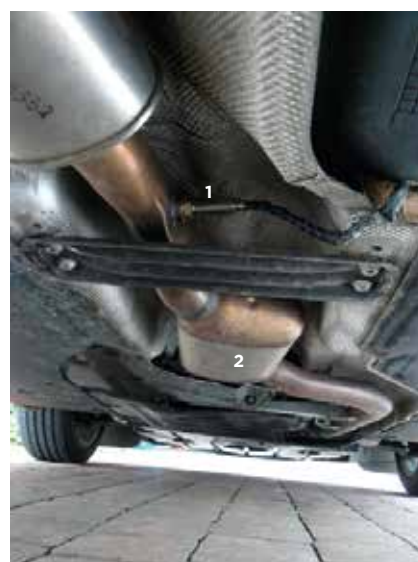
❶ A NOx-szonda (1) és áramlási irányban utána a tárolókatalizátor (2)
