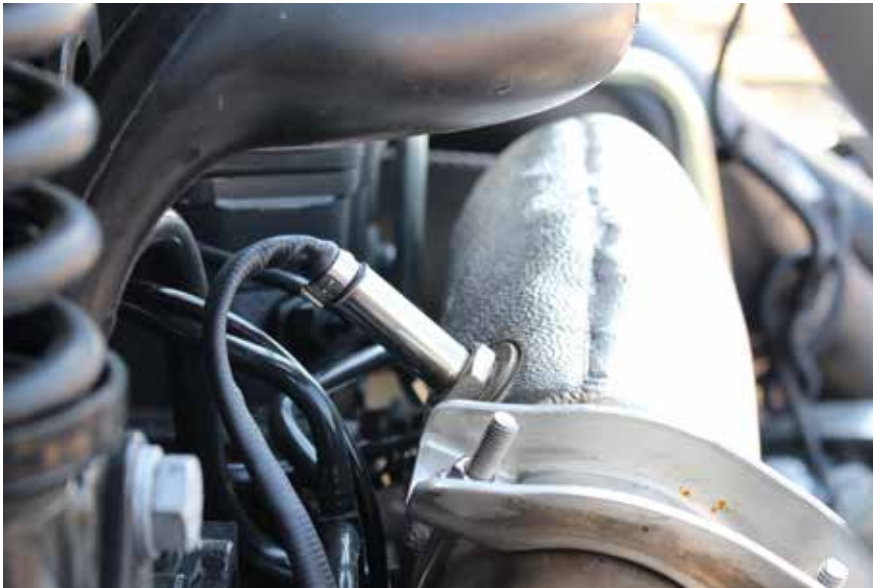
❶ a NO x -szonda egy Euro VI IVECO dízelmotor turbótöltő utáni, katalizátorok előtti csőszakaszban
