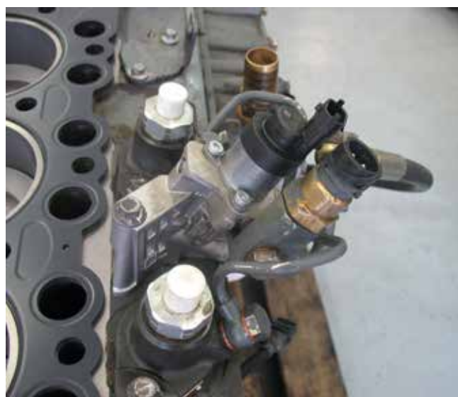
4 Az FCU-egység, 1 - kimenet a stekk-pumpák felé, 2 - visszafolyás a tüzelőanyag-tartályba, 3 - nyomáshatároló szelep és null adagmennyiség-fojtás, 4 - gázolajbelépés az előszállító szivattyútól, 5 - FCU (ZME)
