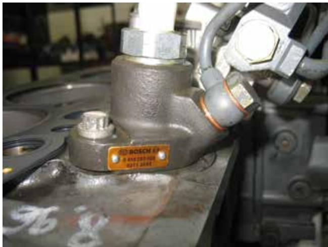
3 Bosch Mico nagynyomású szivattyú (Bosch 0414693005 DEUTZ OEM 02113694)
