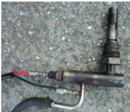
8 A piros színű vezeték a pozitív tápfeszültséget adja, a fekete a gyertya testelése
