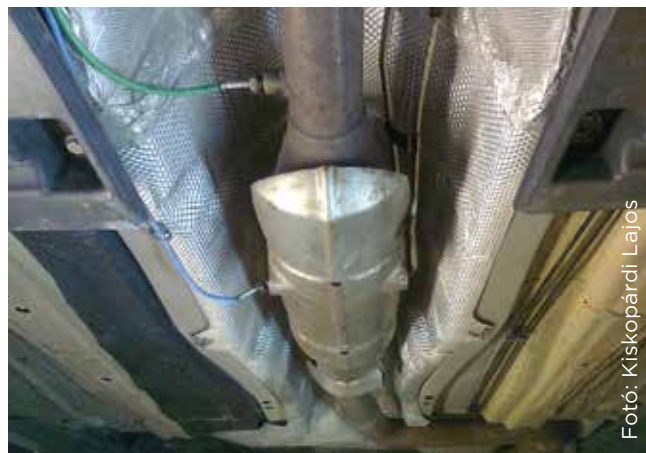
5 A gépkocsiba épített DEC- és cDPF-egység, a hőmérők és a nyomásérvételi csövek
