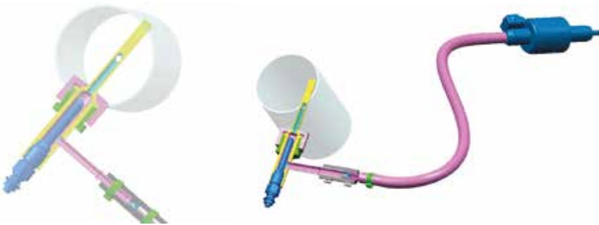
7 A párologtatóban az izzógyertya elhelyezése és a gázolaj hozzavezetése
