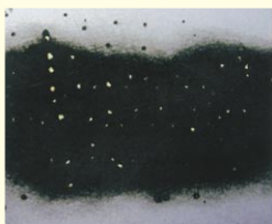
1. ábra: alumíniumfelületen az acélrészecskék és a korróziós folyamat
