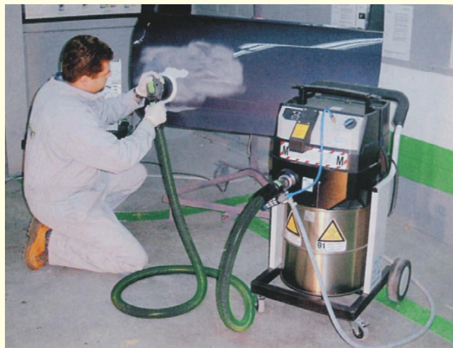
2. ábra: a Festo cég alumíniumfelületek csiszolására kifejlesztett berendezése
