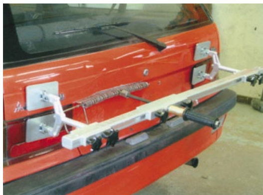
4. ábra: az FL-120 jelű horpadáskihúzó gyakorlati alkalmazása
