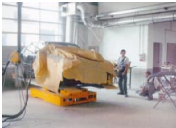
4. ábra: a félkész gépkocsi szállítása
