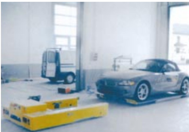
2. ábra: gépkocsi az emelőn és előtte a szállítókocsi
