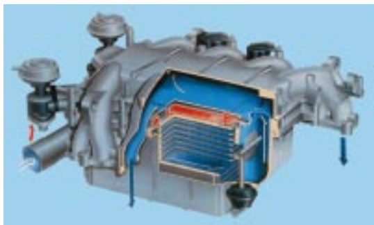
A V8 hengerű Audi A8-as integrált, indirekt töltőlevegő- és kipufogógáz-hűtője
