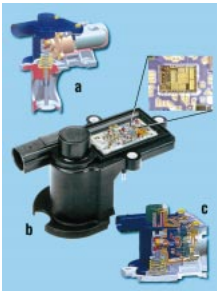
Az elektronikus működésszabályozású kipufogógáz-visszavezető szelep (a) közös egységet alkot vezérlőelektronikájával (b), léptetőmotorjával és annak hajtóművével (c)
