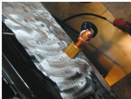
3. ábra: a testkábel végső rögzítése
