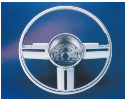
2. ábra: VW Lupo TDI gépkocsi magnézium-ötvözetből készített kormánykereke
