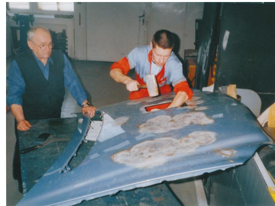
6. ábra: a deformálódott terület hidegen egyengetése
