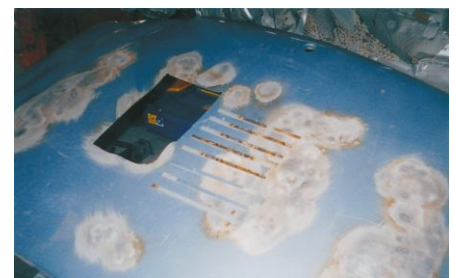
2. ábra: a melegen alakított lemezből próbatesteket készítettünk
