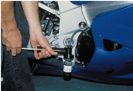
Adott km-futásnak megfelelő használtolajminta begyűjtése
