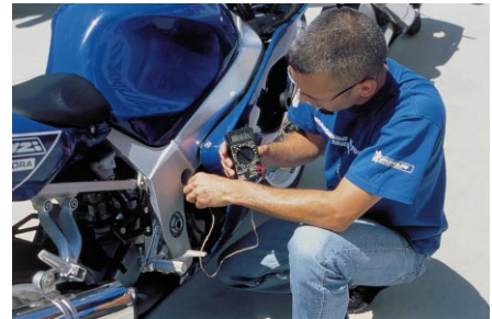
Motorolaj működési hőmérsékletének mérése digitális szondával
