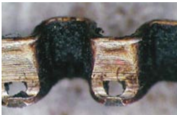
7. ábra: MF-gyűrű rugójának és acéllemezének másodlagos (belső felületek) kopása
