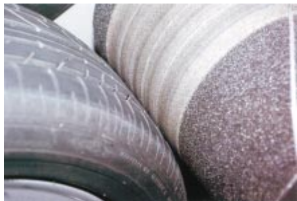
A terhelő-mérő görgő maximum 6,4 kN erővel (több mint 600 kilóval) nyomja a forgó kereket
