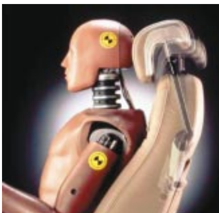
A Saab autógyár SAHR néven kifejlesztett aktív fejtámlája, a nyakcsigolya-sérülések csökkentésére
