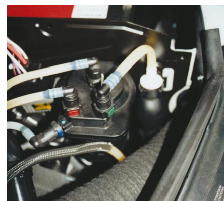
5. ábra: a Renault Clio gázolajszűrőegysége a légtelenítő szivattyúval
